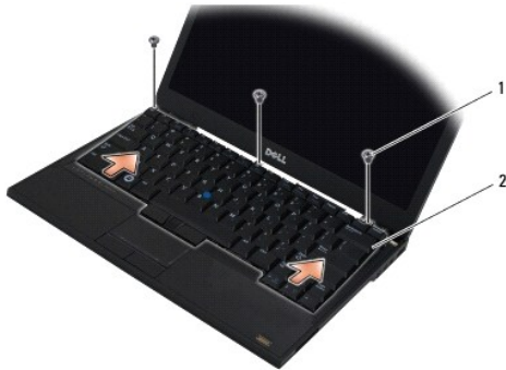
1 M2 x 3-mm-Schrauben (3) 2 Tastatur
